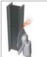
Limpieza mecánica ó química
